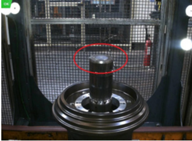
Şekil 3: Dinamik balans ünitesi alt gövde üzerindeki kontrol edilen yüzey
