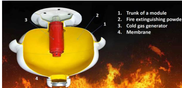
Şekil 7. IPR Modülü iç yapısı [2]
