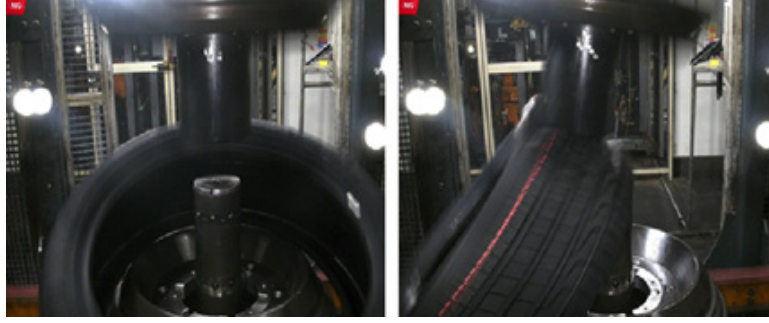
Şekil 1: Lastiğin ölçüm istasyonuna yan oturduğu durumlar
