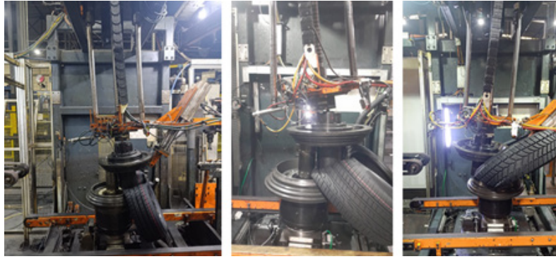
Şekil 2: Lastiğin ölçüm istasyonuna merkezless geldiği durumlarda yaşanan çarpışma görüntüleri
